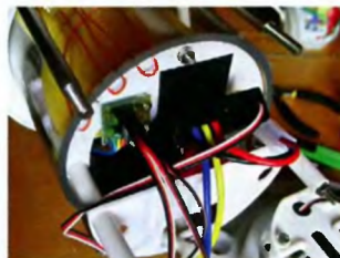
Рулевые машинки крепятся саморезами в пластмассовом блоке, который потом привинчивается к заднему шпангоуту.
