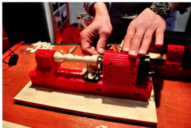
На токарном станке можно выточить мелкую балясину, например.
