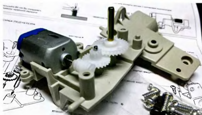
Устанавливаем моторчик в одну из половинок корпуса редуктора. Потом в соответствии с инструкцией втыкаем пластиковые шестерёнки редуктора. Накрываем другой половиной и закручиваем пару винтов. Двигательная установка собрана.
