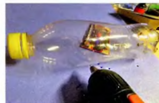
Вдоль бутылки просверлено три ряда отверстий с шагом примерно около 10 мм.
