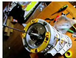
На задний шпангоут накладывается «крышка» из оргстекла, на которой крепится ходовой двигатель, под неё подкладывается кольцевая резиновая прокладка, и шестью винтами крышка стягивается с шпангоутом.
