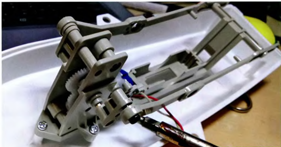
Теперь закрепляем приводные балки для вёсел. Каждая из них фиксируется шурупом. Размещаем клеммы и выключатель.
