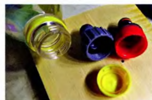
Диаметр коннектора для шланга 3/4 дюйма практически такой же, как у крышки пластиковой бутылки. Только на бутылку его навернуть не получается, резьба разная. Один из коннекторов был распилен и приклеен к крышке бутылки. Чтобы надёжно
