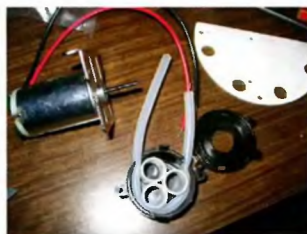
Сложнее всего мне далась сборка помпы, три пластиковых цилиндра никак не хотели влезать вместе с силиконовой трубкой в корпус. Что-то из них оказывалось лишним.
