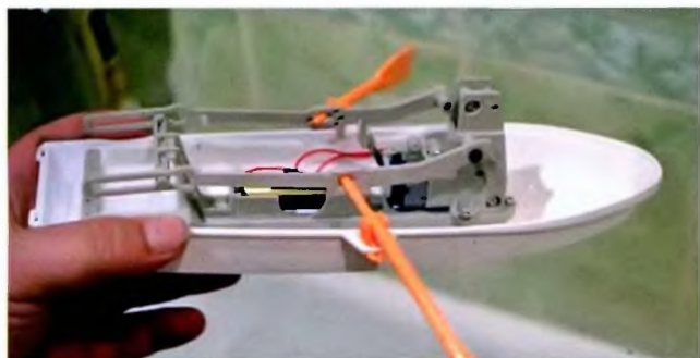
Перед спуском на воду приводим вёсла в рабочее положение. Ручку весла вставляем в отверстие приводной балки. Можно спускаться на воду.
