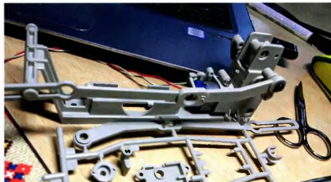
Устанавливаем моторчик в одну из половинок корпуса редуктора. Потом в соответствии с инструкцией втыкаем пластиковые шестерёнки редуктора. Накрываем другой половиной и закручиваем пару винтов. Двигательная установка собрана.
