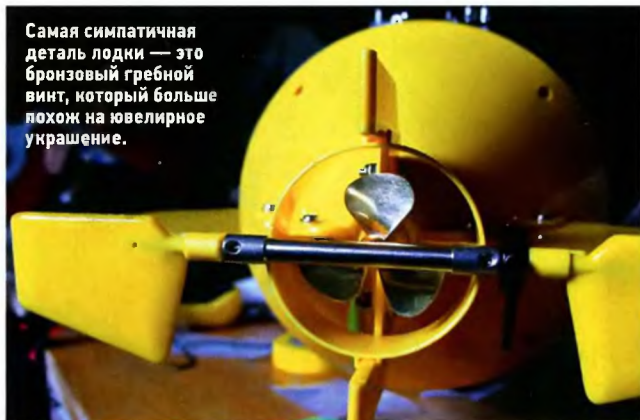
После герметизации лодки сзади привинчивается негерметичный хвост, на него навешивается руль направления и рули глубины, на вал устанавливается винт.
