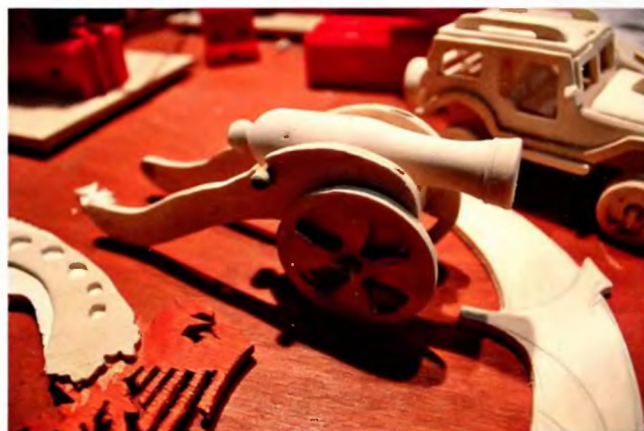
Модель пушки. Ствол вытачиваем на токарном станке, колёса и лафет выпилены лобзиком из 3-мм фанеры. Ещё понадобится шлифстанок, чтобы подравнять вырезанные детали.
