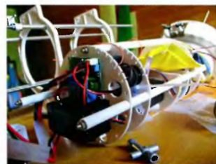
Вся электроника крепится на переборках внутреннего блока, снизу свинцовый аккумулятор на 2 А*ч, сверху балластная цистерна.
