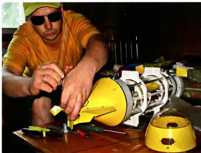
После герметизации лодки сзади привинчивается негерметичный хвост, на него навешивается руль направления и рули глубины, на вал устанавливается винт.
